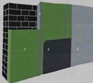
1. Buitengevel | 2. Isolatie | 3. Dampschermb | 4. Binnenafwerking | 5. Stijl- en regelwerk (optioneel)
